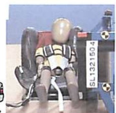
チャイルドシートの側面衝突試験
